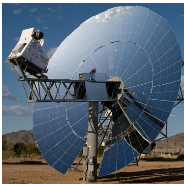
1.7 – сурет – Стирлинг қозғалтқышы бар параболоид концентратор
